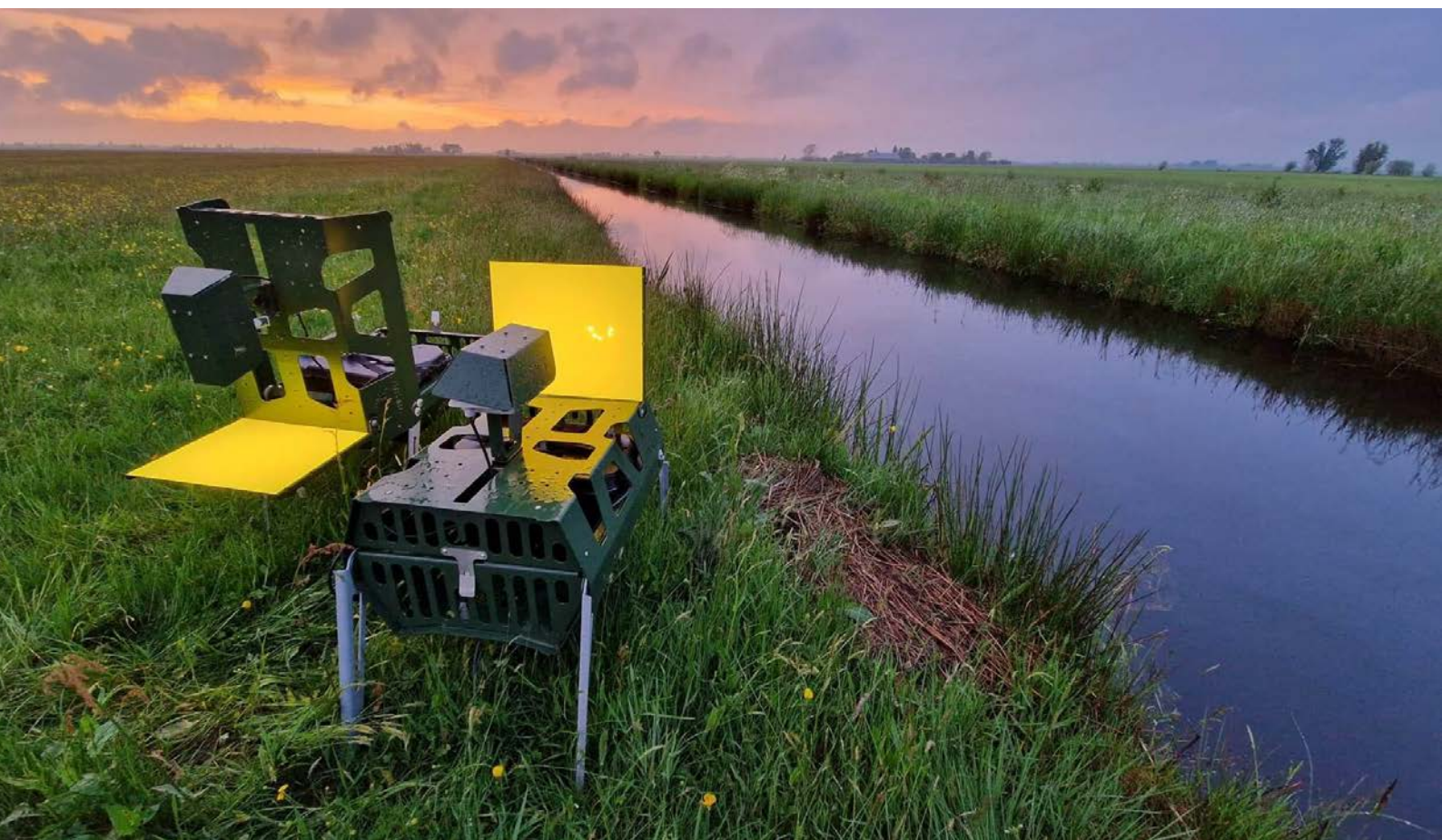
Afbeelding 2.2. Meetlocatie in agrarische omgeving waarbij verticale en horizontale plaatsing naast elkaar getest worden (Foto: Faunabit).
